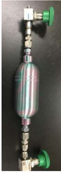
図2：実験に用いるリアクターの写真。中心に液体CO 2 が封入されるボンベがあり、両側に開閉可能なバルブがある。
