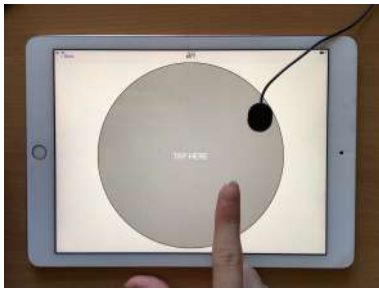
Figure 1: 振動センサを iPad に取り付けた様子
