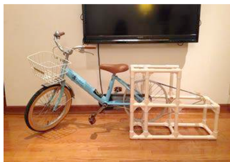
図6：廃棄自転車とPVCを用いた紡績機
