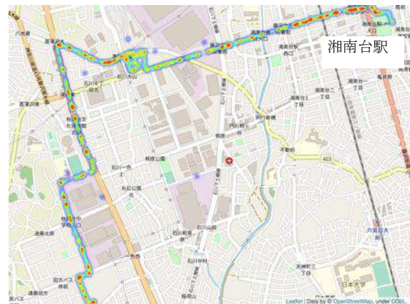
図7：湘南台から遠藤方面を走るゴミ収集車設置センサーによるPM2.5濃度分布
