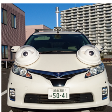
図2：第1次プロトタイプを自動運転車に搭載した状態 二つのユニットはヘッドライトの上に設置されている。
