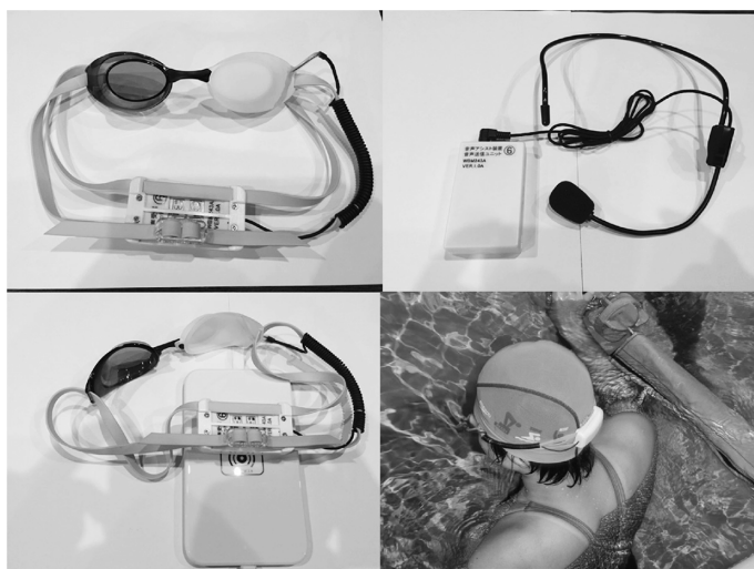
写真2 無線骨伝導スピーカーゴーグル。左上: 全体像、右上: 送信機、左下: 非接触充電の様子、右下: 選手が装着している様子
