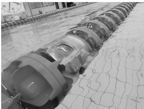
写真 3 壁接近検知装置（水上から見たところ）
