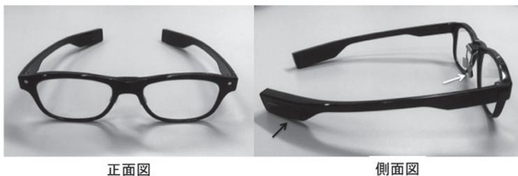
図 1 われわれが開発した加速度、角速度計付メガネ型ウェアラブルセンサー
