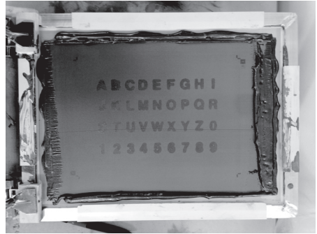
図9 シルクスクリーンを用いて定着する様子
