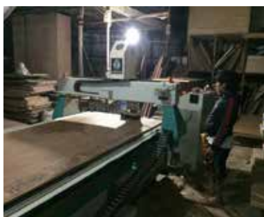
[9月] 建具工場の CNC ルーターでパーツの切り出し。
