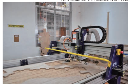
合板をカットする FabLab 内にある CNC ルーター
